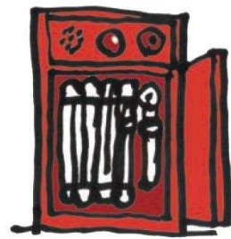
屋内消火栓設備
