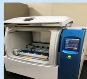
PCR検査を行う測定機器
